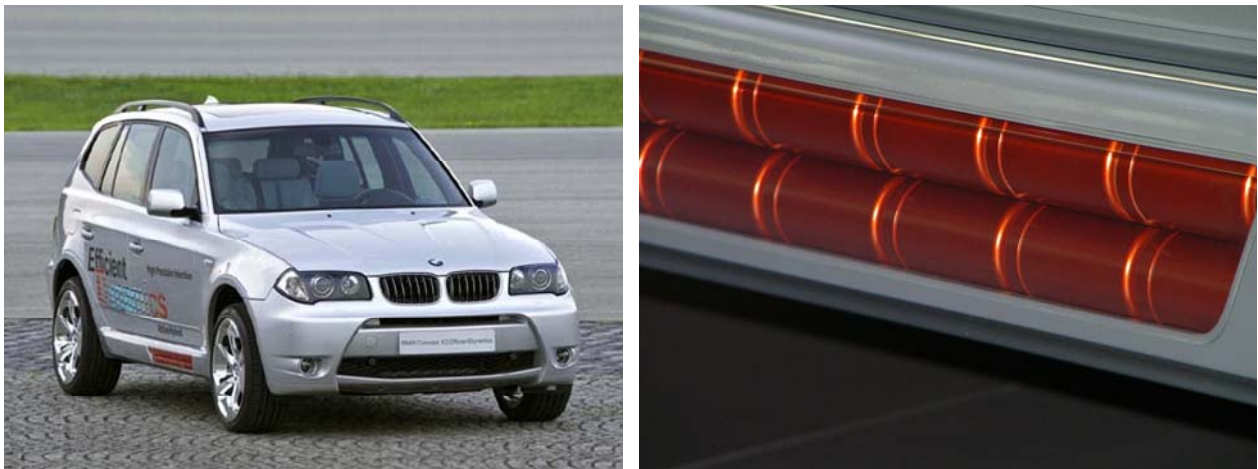
Bild 7: BMW X3 EfficientDynamics. Links die im Seitenschweller untergebrachten Ultrakondensatoren
